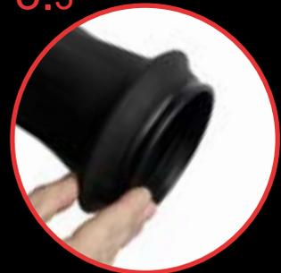
den Handschuhring (HS) des Ersatzteil-kits, mit dem kleineren Durchmesser, über den Manschettenschutzring schieben
